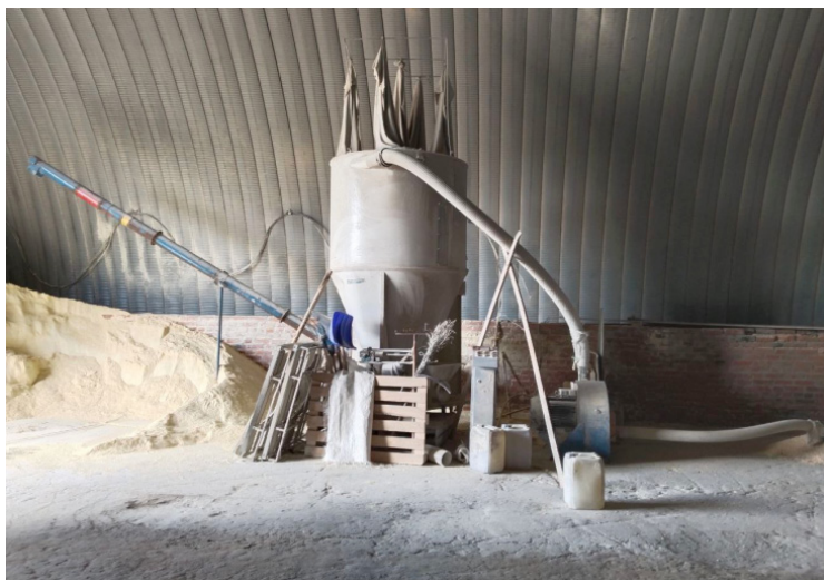
Рисунок 1 – Дробилка роторная (ДКР) для измельчения зерна кукурузы, диаметр отверстий сита 3 мм
