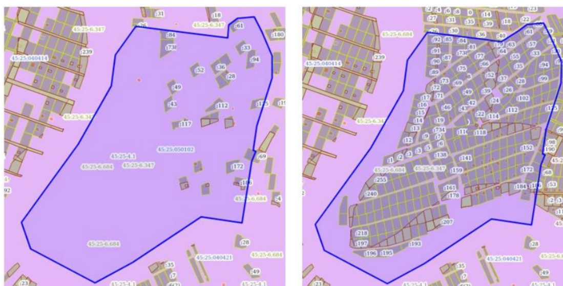
Рисунок 3 – Кадастровый квартал до и после проведения ККР
