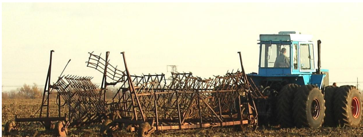
Рисунок 2 – Трактор ХТЗ-160 в агрегате с прицепной сцепкой борон СГ-21
