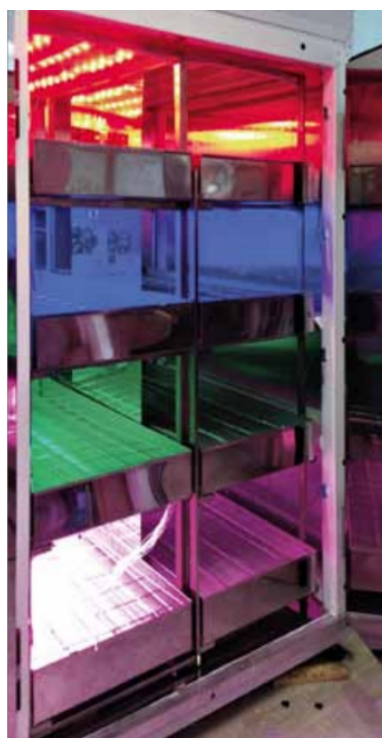
Рисунок 2 – Полочная камера синерготрона (модель 1.01, производство АНО «Институт стратегий развития», Москва)
