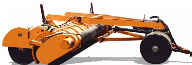
Рисунок 2 – Профилировщик торфяной шнековый АМКОДОР АТ-51
