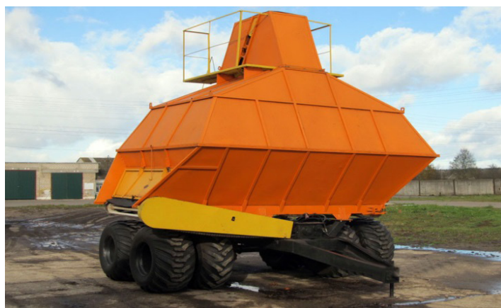
Рисунок 6 – Машина для уборки фрезерного торфа МТФ-43А-К
