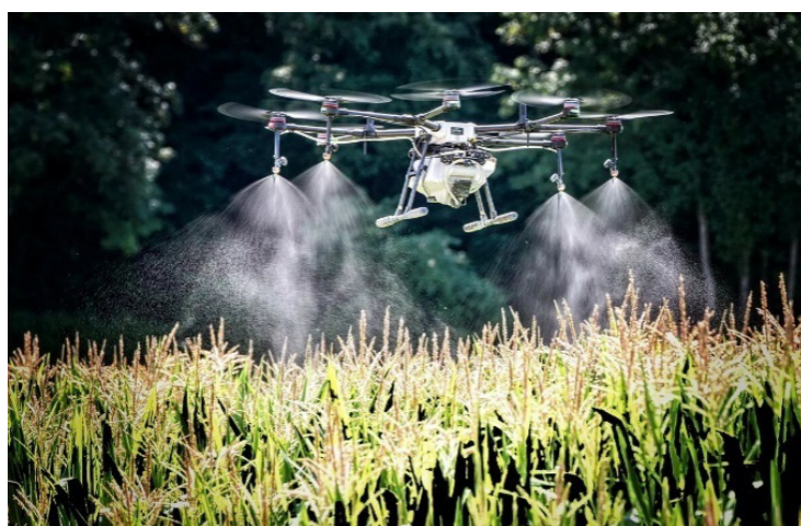
Рисунок 7 – Опрыскивание посевов с помощью дрона (взято из общего доступа)
