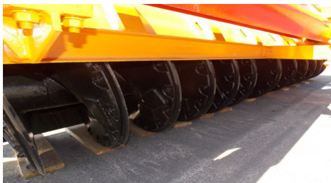
Рисунок 3 – Шнековый аппарат пирофилировщика торфяного шнекового АМКОДОР АТ-51
