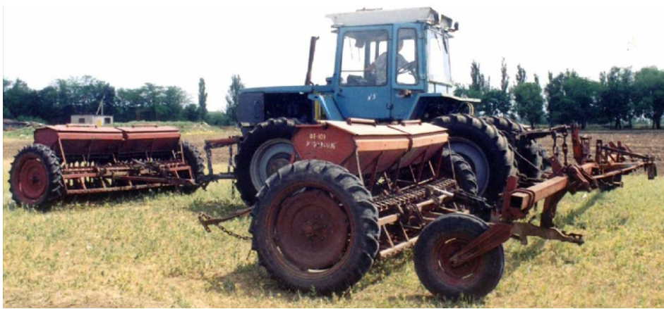
Рисунок 6 – Посевной МТА на основе полунавесной сцепки СН-75
