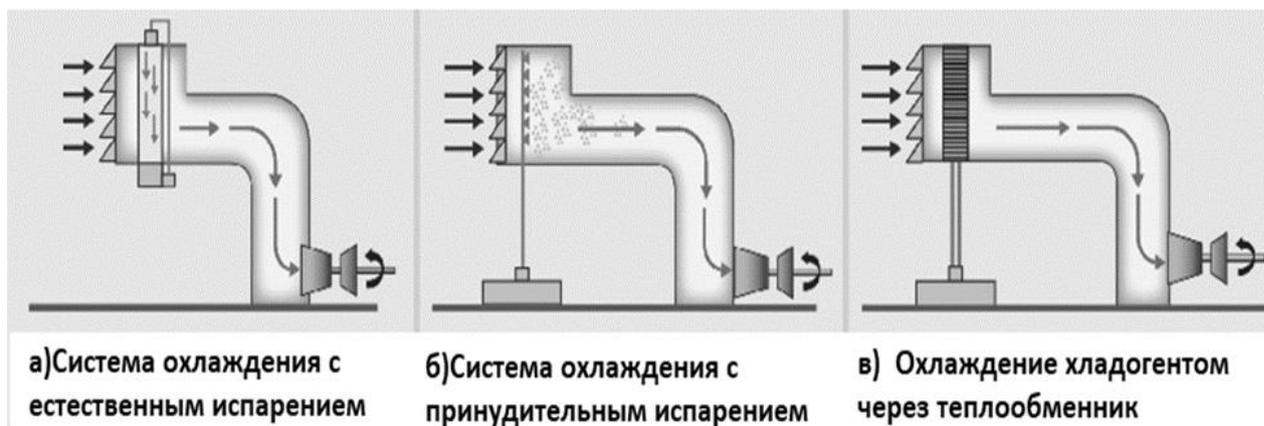
Рисунок 3 – Схемы испарительных систем охлаждения воздуха перед компрессором ГТУ
