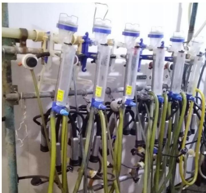
Рисунок 1 – Доильные аппараты, входящие в состав доильной установки АДМ-8А
