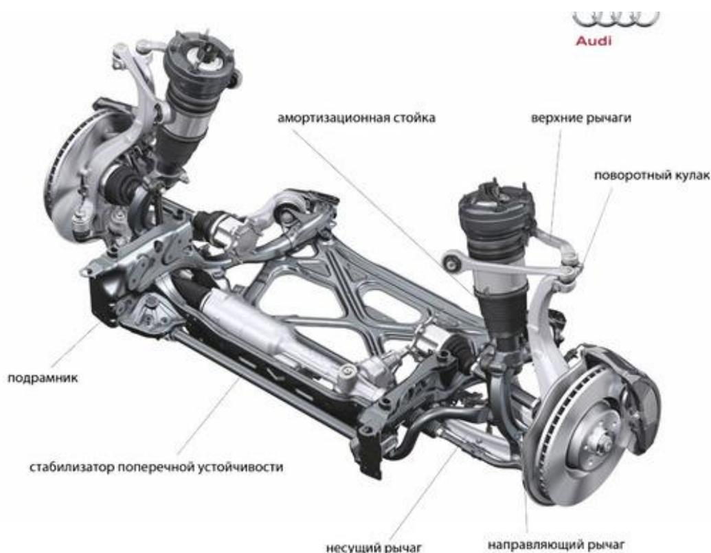
Рисунок 3 – Устройство многорычажной подвески
