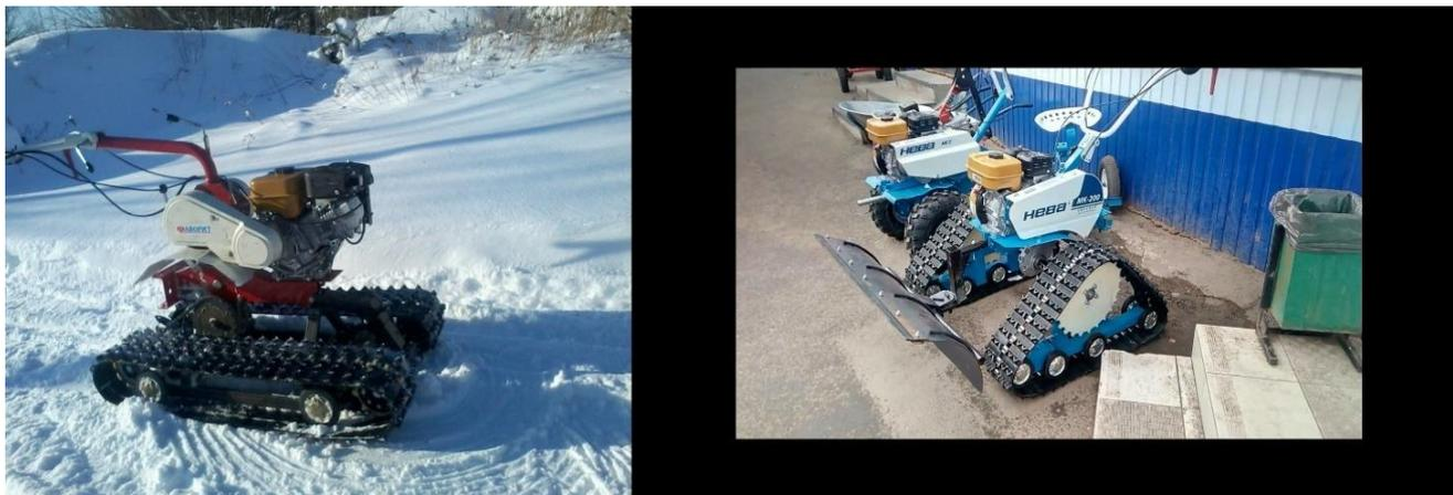
Рисунок 5 – СП-МБ-Ф Снегоходная приставка к мотоблоку Фаворит, Скиф;
