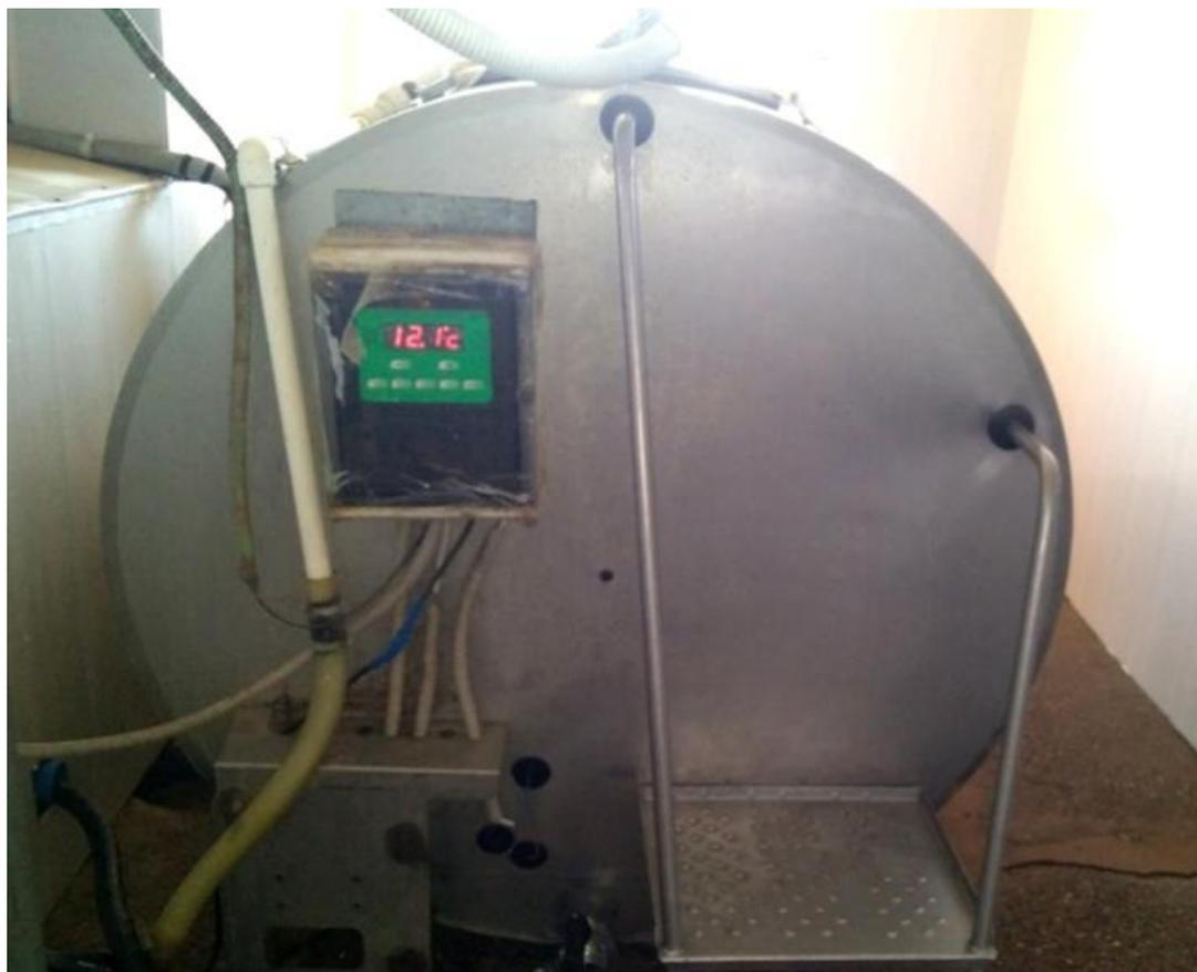
Рисунок 3 – Молочный танк, входящий в состав доильной установки АДМ-8А
