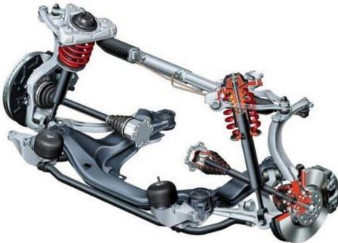
Рисунок 1 – Передняя подвеска автомобиля
