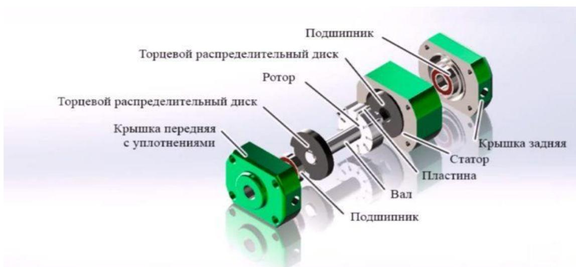
Рисунок 2 – Устройство пластинчатого насоса
