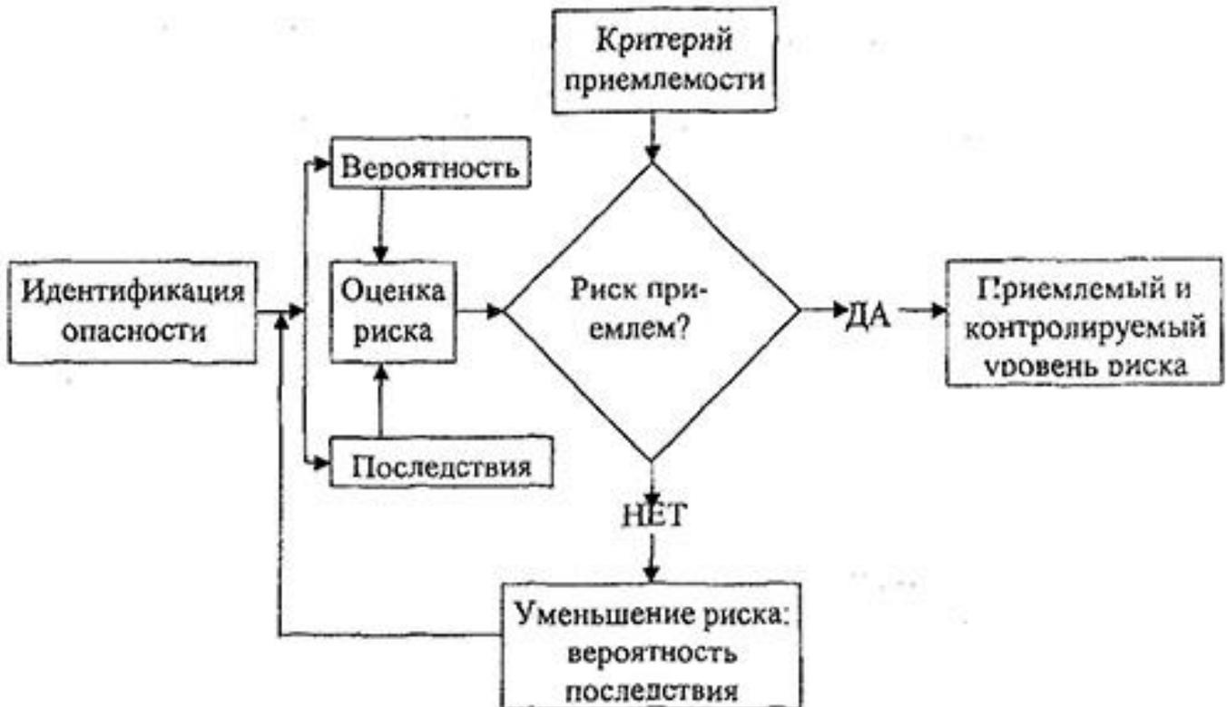
Рисунок 1 □ Схема анализа техногенного риска
