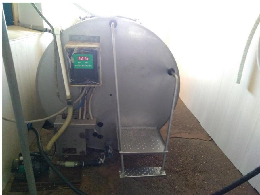
Рисунок 2 – Танк-охладитель молока закрытого типа
