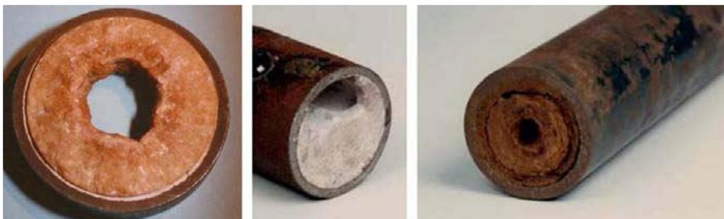
Рисунок 1 – Слой накипи в тепловых трубах при отсутствии водоподготовки в котельных
