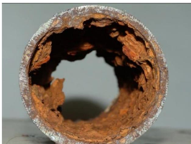
Рисунок 2 – Коррозия поверхности трубы при отсутствии водоподготовки в котельных
