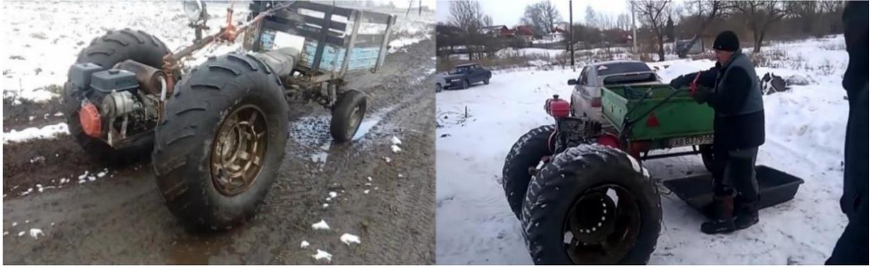
Рисунок 2 – Увеличение проходимости с помощью колес большего диаметра
