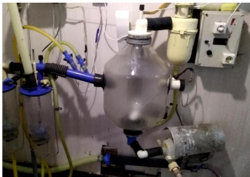
Рисунок 2 – Молокосорник, входящий в состав доильной установки АДМ-8А
