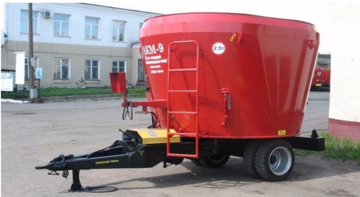
Рисунок 2 – Внешний вид кормораздатчика со смесителем АКМ-9
