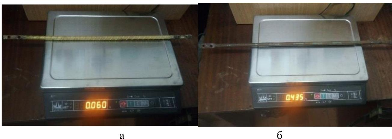
Рисунок 1 – Сравнительный анализ весовых характеристик прутков элеватора
