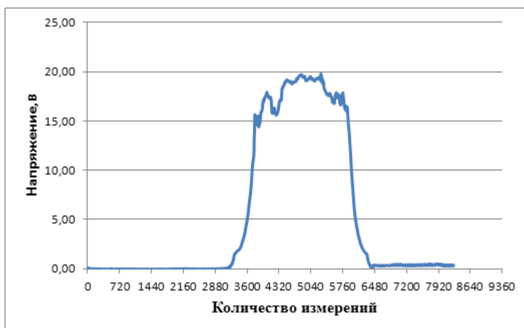
Рисунок 3 – График выработки электрической энергии фотоэлектрическим преобразователем
