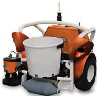
Amazonе разработала робот под названием BoniRob. Его задача – изучение состояния урожая на полях. Система управления позволяет этим роботам передвигаться между растениями, исследуя их характеристики.
